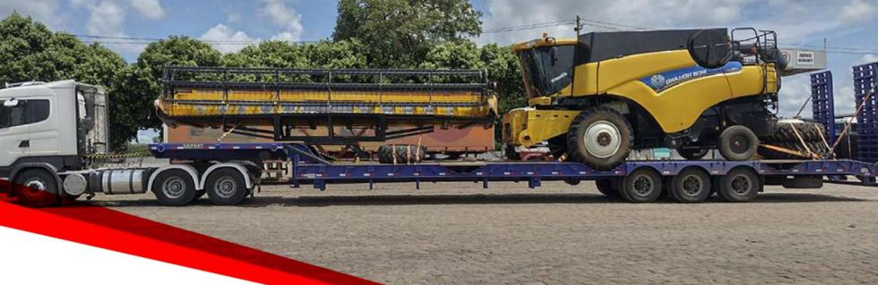
A **PRANCHA AGRÍCOLA TEIXEIRA** é projetada para ter o melhor desempenho em seu carregamento. Fabricada com matéria-prima nacional de altíssima qualidade, sendo a sua estrutura desenvolvida em **PERFIL W** (VIGA I), com cobertura em chapa sobre os rodados, para garantir um carregamento mais eficiente e seguro. Seu assoalho é montado com pranchas de 50 mm de espessura em madeira de lei.
