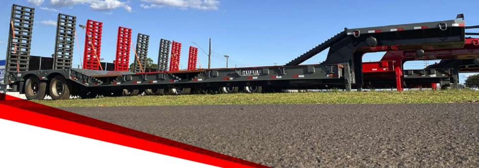
A **PRANCHA REBAIXADA TEIXEIRA** é projetada para ter o melhor desempenho em seu carregamento. Fabricada com matéria-prima nacional de altíssima qualidade, sendo a sua estrutura desenvolvida em **PERFIL W** (VIGA I), com cobertura em chapa sobre os rodados, para garantir um carregamento mais eficiente e seguro.
